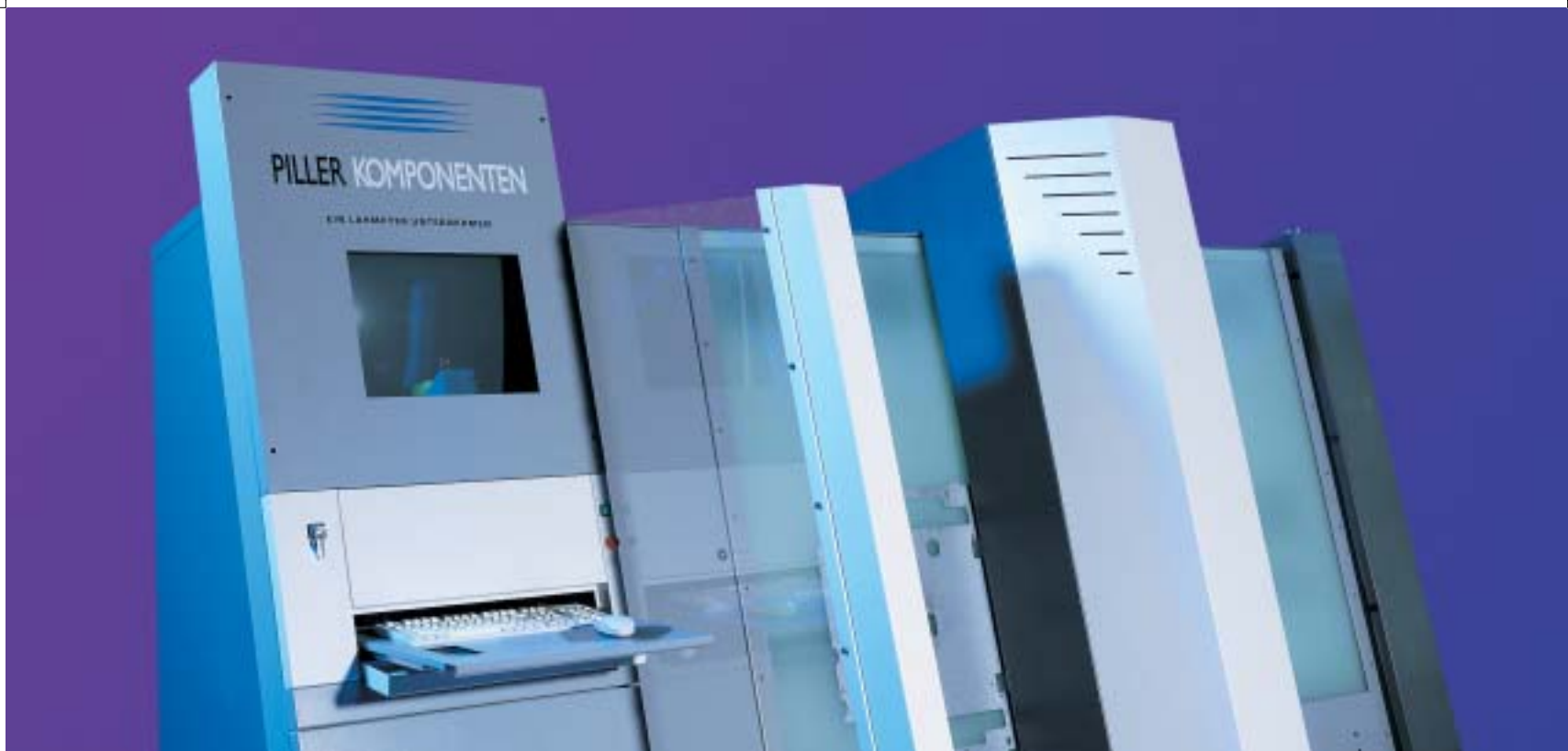
Digitale Qualitätsprüfung gibt Sicherheit – Prüfgenaugigkeit \leq 0,05 mm. Fertige Platinen werden optisch mit entsprechenden CAD-Dateien verglichen
