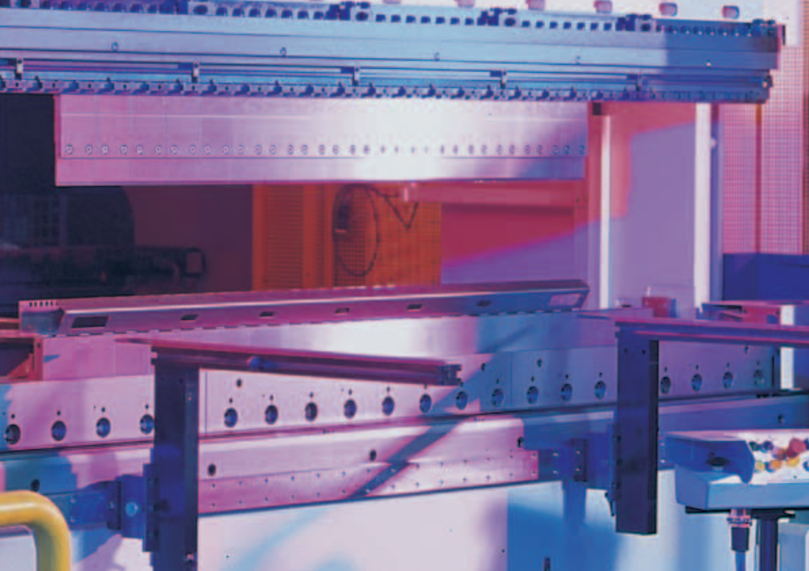
HÄMMERLE CNC-Abkantpresse mit 15 gesteuerten Achsen, 2.000 kN bis 3.000 mm Länge
